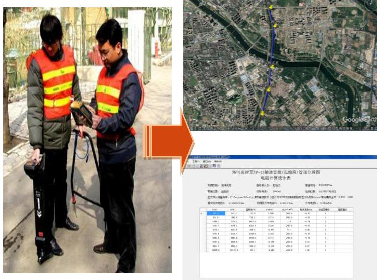
接收机与 MG8 系列手持 GPS 通过蓝牙实现数据传输，接收机测取的数据会全方位展示在 PCM-Logger 软件，并会记录下数据采集点的 GPS 信息。软件导出的 KML 格式文件可直接通过 Google 地球软件打开，检测路由及相关检测数据可在三维地图中进行展示；导出 PDS 格式文件，可直接导入 ESTEC 软件进行分析。PCM-Logger 软件优化了现场检测流程，提高了数据处理效率，是管道外防腐层检测的高能工具。
