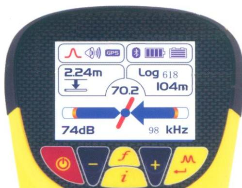
DM 接收机有三种定位模式，峰值法、谷值法、峰值带箭头法，可有效提高现场定位精度及检测速度。在现场电流测量数据的同时，接收机会实时绘制电流曲线图，帮助检测人员进行现场分析，及时发现缺陷点，快速定位破损点。
