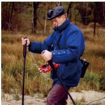
CIPS现场检测图
